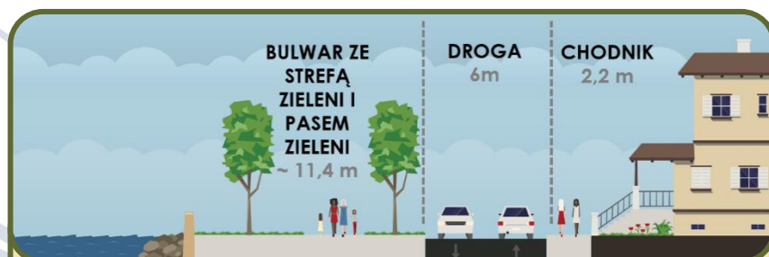
Ryc. 31: przykładowy przekrój bulwaru północnego (z pasem zieleni). 6
